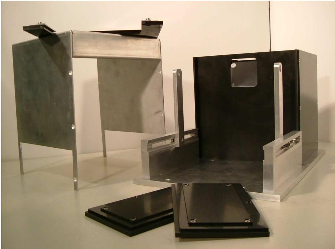
Fotografia dei componenti della camera per l'alloggiamento dello scintillatore e del rivelatore CCD
